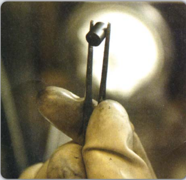
يجب تصنيع حبيبات الوقود من البلوتونيوم بشكل دقيق.
