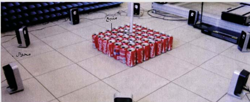
الشكل 3. بلورة مكونة من 49 علبة من الصودا يمكن أن تهتز وفق نمط مختلف للاهتزاز تمتد تواتراتها من 340 إلى 420Hz، في حين أن العلبة المنفردة تهتز بالتواتر 420Hz. عندما تستقبل إحدى العلب إشارة صوتية طولها نحو بضعة ملي ثانية تثار كافة أنماط البلورة وتستقبل محاويل بعيدة محصلة انضمام هذه الأنماط. تتركز الإشارة بعد الانقلاب الزمني على العلبة الوحيدة حيث كان يقع المنبع، بمقدرة فصل قدرها \lambda/25 .
