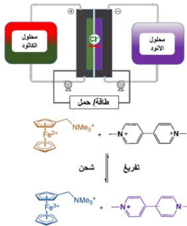
مخطط ترسيمي لبطارية التدفق العضوية في الوسط الملحي المعتدل، وتفاعلات الخلية
