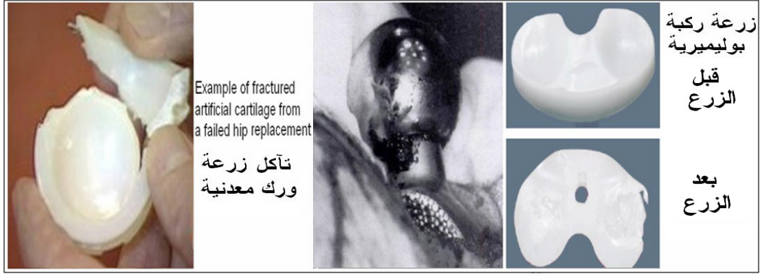
الشكل (6) تدهور زرعة ركببة بوليميرية وتآكل زرعة ورك معدنية بعد استئثارهما في جسم لنحو 13 عاماً.
