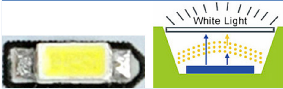
الشكل 28. طريقة الحصول على الضوء الأبيض من مزج الضوء الأزرق الصادر عن مصباح الليد مع طبقة الفسفور الأصفر المحيطة به.
