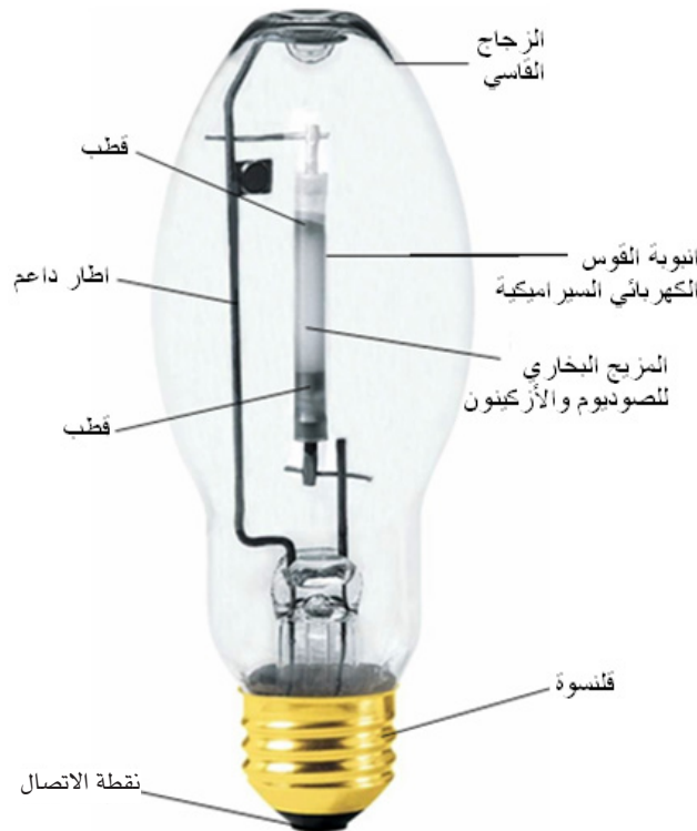
الشكل 16. مصباح بخار الصوديوم ذو الضغط المرتفع مع أقسامه الرئيسية.
