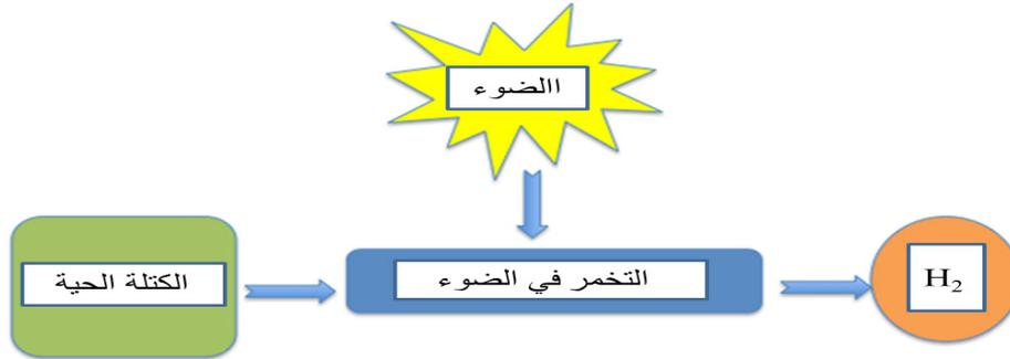
الشكل 4. إنتاج الهيدروجين الحيوي من الطحالب الدقيقة بواسطة عملية التخمير في الضوء.
