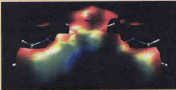
تمثيل، حسب بإحدى طرائق الكيمياء الكمومية، للكيمون الكهراكدي حول جزيء من بيتريا زينيل - بيريدين (BTP) (bis-triazinyl - pyridine)، المطور بطريقة سانكس Sanex لفصل الأكتينيدات واللانثانيدات.
