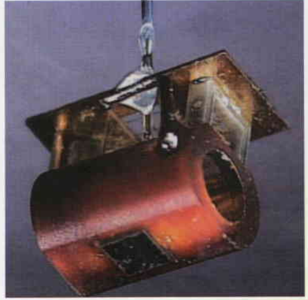
تجويف (طوله 2.7 م) مخصص لاستخدامه كدريلة لخط الدمج الليزري الذي تم تجريبه على منشأة أومفا في جامعة روتشستر في إطار الاتفاق الفرنسي الأمريكي بشأن الاندماج بالحصص العنقالي.
