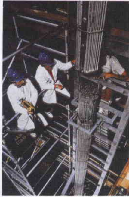
منظر جزئي للمنشأة بتسي، التي استثمرت بين 1998 و الطاقة الذرية في غرونوبل، يُعَمَّل في مقياس مختزل (1/100) حجما، ومقياس 1 ارتضاعا) مجموعة دارات المضاعل بالماء المضغوط استطاعته 900MWe
