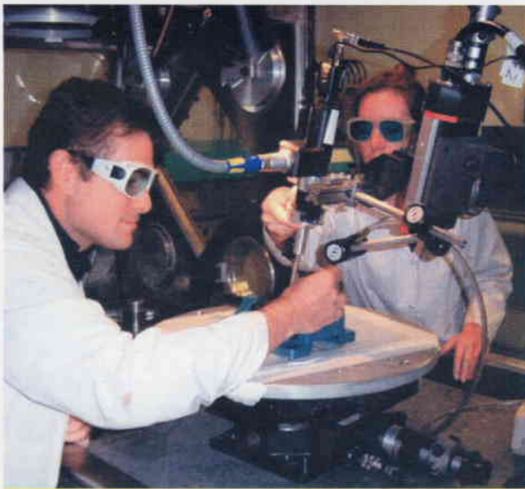
تحضير عملية اللحام بالليزر YAG النبضاني عند تنفيذ مستوى التجارب
