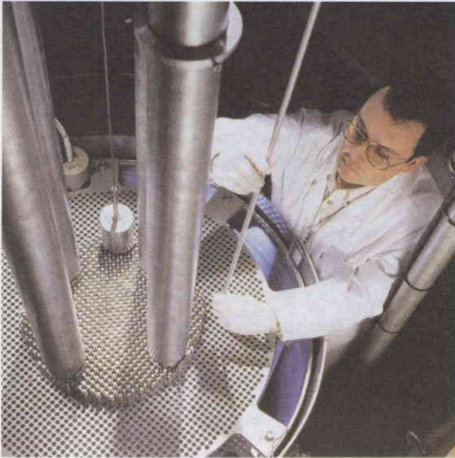
عملية وضع ابر من وقود اكسيد اليورانيوم في قلب النموذج المصغر الحرج ايلول
