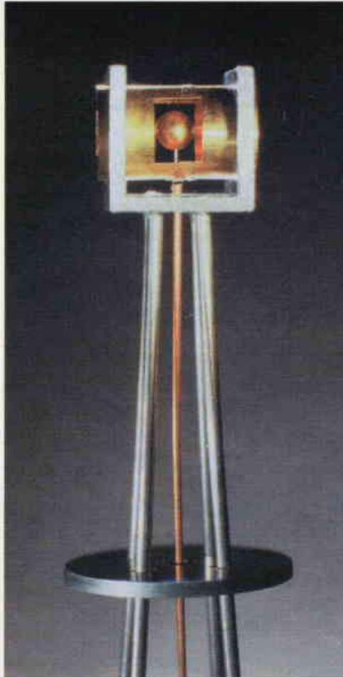
مقال على هدف صُمم لتجربة الليزر ميغا جول. يتامن التبريد اللازم للكرة المكروية، المكوّنة من قوقعة لدنة ودوتريوم - تريتيوم داخل الجوف الأسطواني من الذهب، بجريان مائع مُبرّد.
