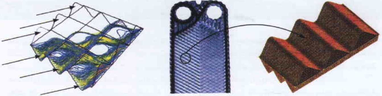
الشكل 2- مسارات يتبعها المائع ضمن مبادل ذي صفيحات ووصلات زاوية حيث تشكل الخطوط المشرشرة زاوية 30° بالنسبة إلى محور الجريان في قعر أخدود. وهذه النتائج التي تم الحصول عليها بمساعدة برمجية "Fluent" تبين جهود النمذجة الموضوعية للجريانات.
