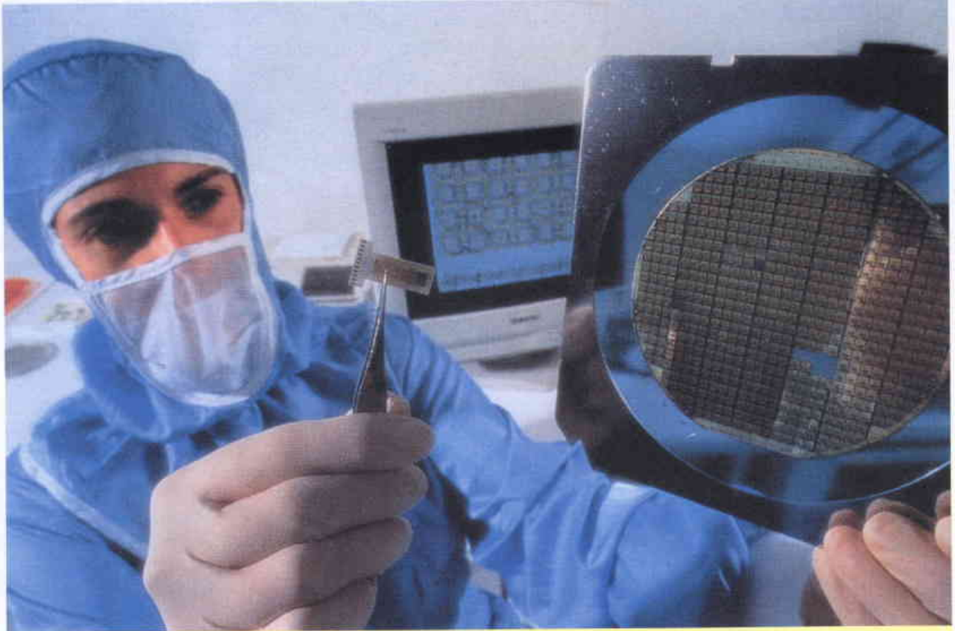
رقاقات ميكام متعددة الإرسال (مقاس 128 رقطة). على شكل طبقة رقيقة (طبقة من السليسيوم، في المستوى الأمامي إلى اليمين) وفي حالة التركيب المنقود (إلى اليسار)
