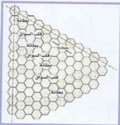
الشكل 11- التصميم SCFR، مقطع نصف قطري للقلب.
