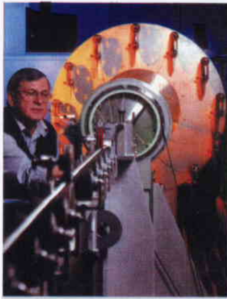
استحراق مزيد من التيار، إن الأسلاك والأشرطة البينة في هذه الصورة والتي أنتجتها شركة سيممنس لأغراض الاختبار، تستطيع نقل تيارات أعلى بكثير مما تستطيع نقله المواد التقليدية ويمكن لذلك استخدامها في صنع محركات كهربائية أكثر قوة وفعالية.
