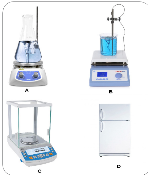
الشكل 34. تابع تجهيزات المخبر الرطب في وحدة إنتاج طعوم الغشاء الأمنيوسي. (A): سخان مع محرك مغناطيسي (BioSan Magnetic Stirrer MSH-300 with heating plate). (B): جهاز خلط مع محرك مغناطيسي (Digital Ceramic Hotplate Stirrer, Thermo mac TM-19D). (C): ميزان إلكتروني حساس (Radwag AS 220.R2 PLUS Analytical Balance). (D): براد منزلي هواء بيايين (Two door no frost refrigerator. (TN/TNSL 2611)).
